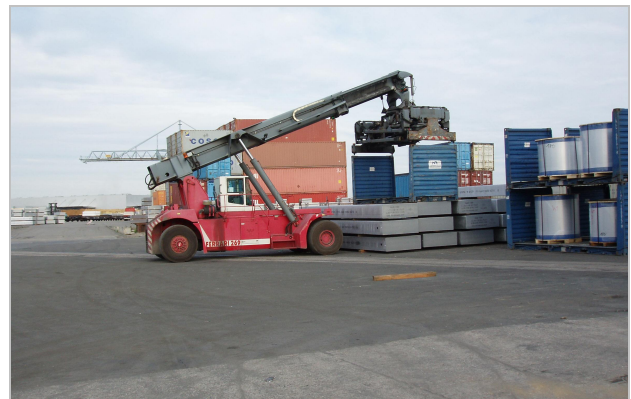
Nutzung der Hafentflächen mit Achslasten von 68,6 Tonnen
